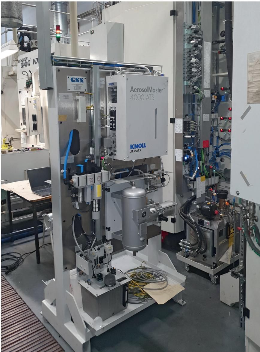
1 GSN rüstete 32 Drehmaschinen von Nassbearbeitung auf die von Knoll angebotene Aerosol-Trockenschmierung um. Im Bild sieht man die platzsparende Anordnung der AerosolMaster-4000-ATS-Geräte zwischen jeweils zwei Maschinen © GSN
