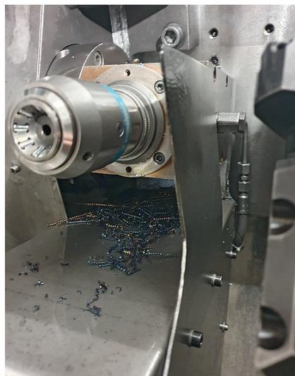
5 Auch die Rolliereinheit für die Kugelzapfen wird vom Knoll-ATS-System mit feinstem Aerosol versorgt © GSN
