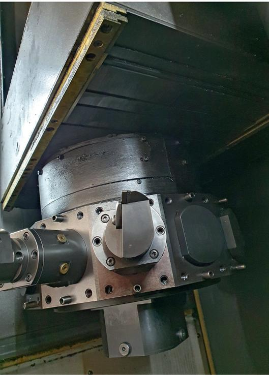
2 Da die Revolver der Drehzentren bereits mit innengekühlten Werkzeugen bestückt sind, war die Umstellung von KSS auf ATS problemlos möglich © GSN
